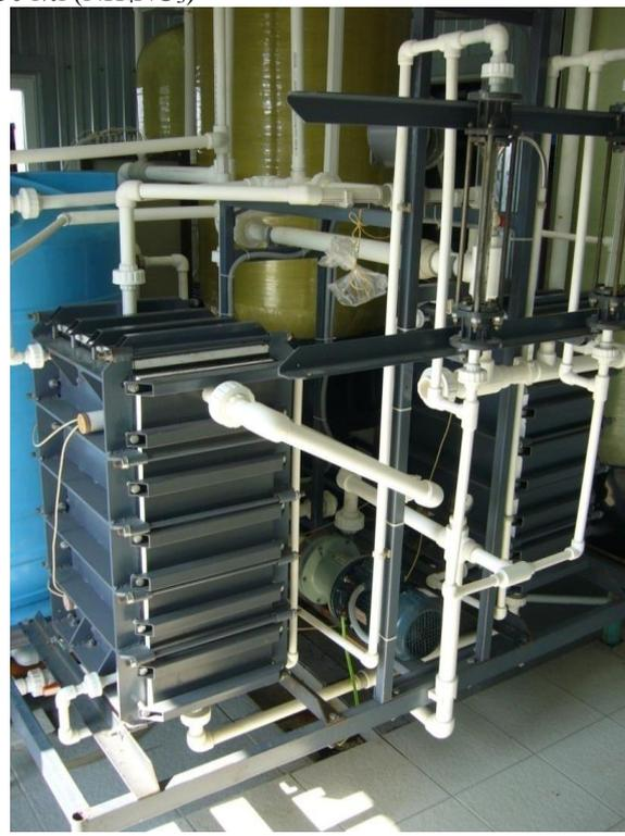
*Блок обратного осмоса и установки электродиализного концентрирования (ЭДК) «Арамид-5» для производства сверхпрочных параарамидных волокон «РУСАР-С»
